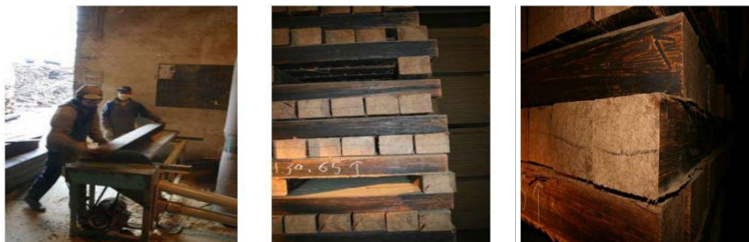
Figure 51: Sciage des poutres
