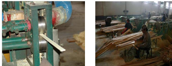
Figure 45: Rectification des lamelles
