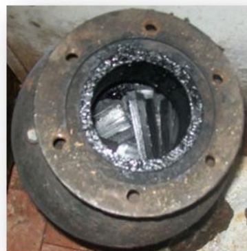
Charbon de bambou dans un réacteur.
