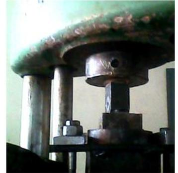
**Photo 12: Presse hydraulique TESTWELL multifonctionnelle (compactage, résistance maximale) au bloc Technique d'Ankatso**
