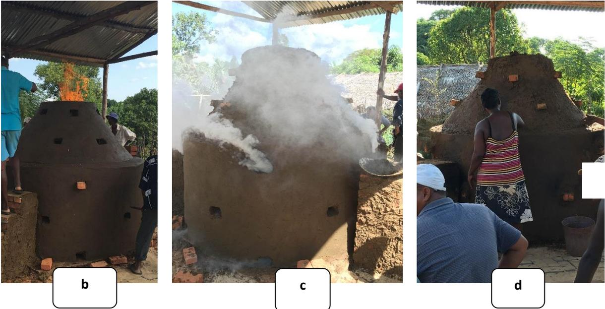
**Photo 9:** Procédé de calcination des sciures de bambou à partir d'un four à dôme (*Centre de Valorisation des Résidus et sciures de Bambou à Mahajanga*)
