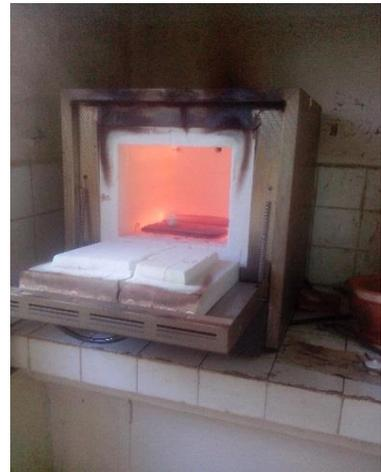
**Photo 8: Four à moufle (Naberther de 30 à 3000°C), Laboratoire OMNIS**
