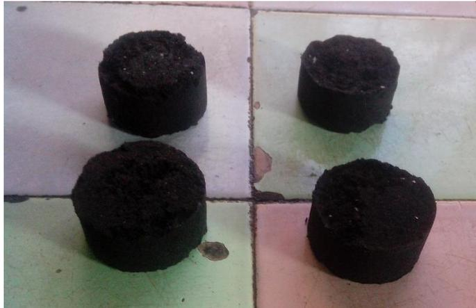
**Photo 13 : Briquette de charbon de bambou**
