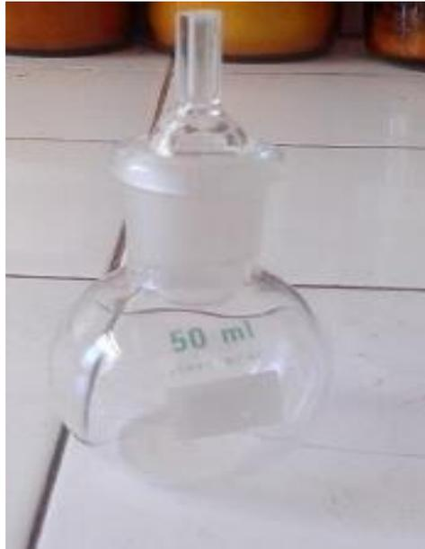
**Photo 5: un pycnomètre**
