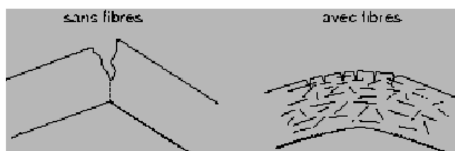
Figure 22 : Fissuration dans le béton sans et avec fibres
