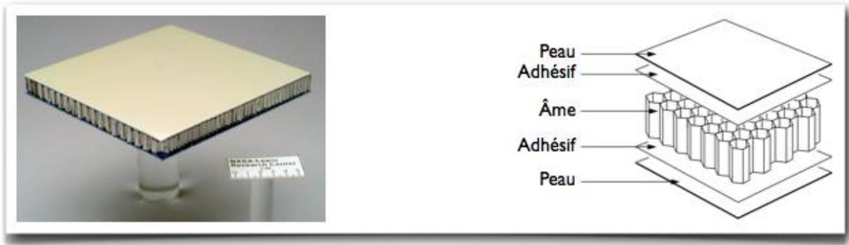
**Figure 1-10: Structure en sandwich**
