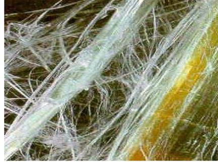
**Photo 2-10 : Fibres d'amiante**
