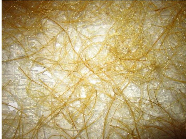
Photo 24. Moulage au contact de fibre de bambou
