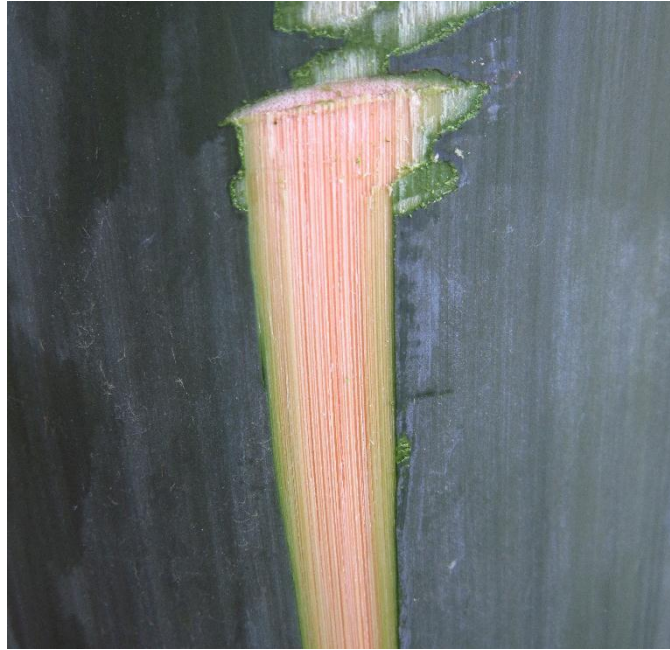
Photo 3. Structure de la chair de bambou
