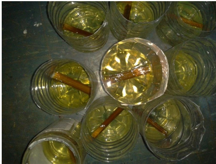
Photo 22. Échantillons immergés dans des solutions à 3 %
