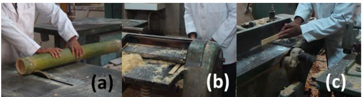
Photo 3 : Opérations d'usinage : débitage (a) ; rabotage (b) ; dégauchissage (c)
