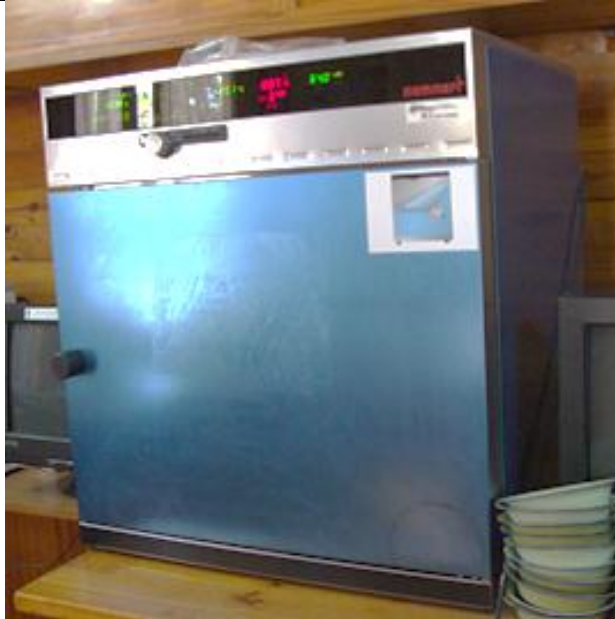
Photo 5 : Enceinte climatique de type Peltier
