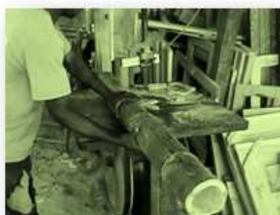
Photo A.1 : Coupes des nœuds avec la scie à ruban
