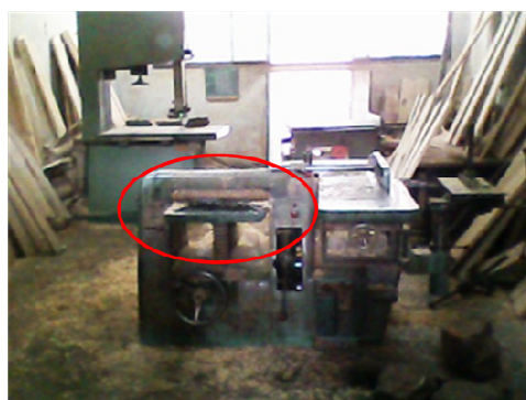
Photo A.9: La machine raboteuse
