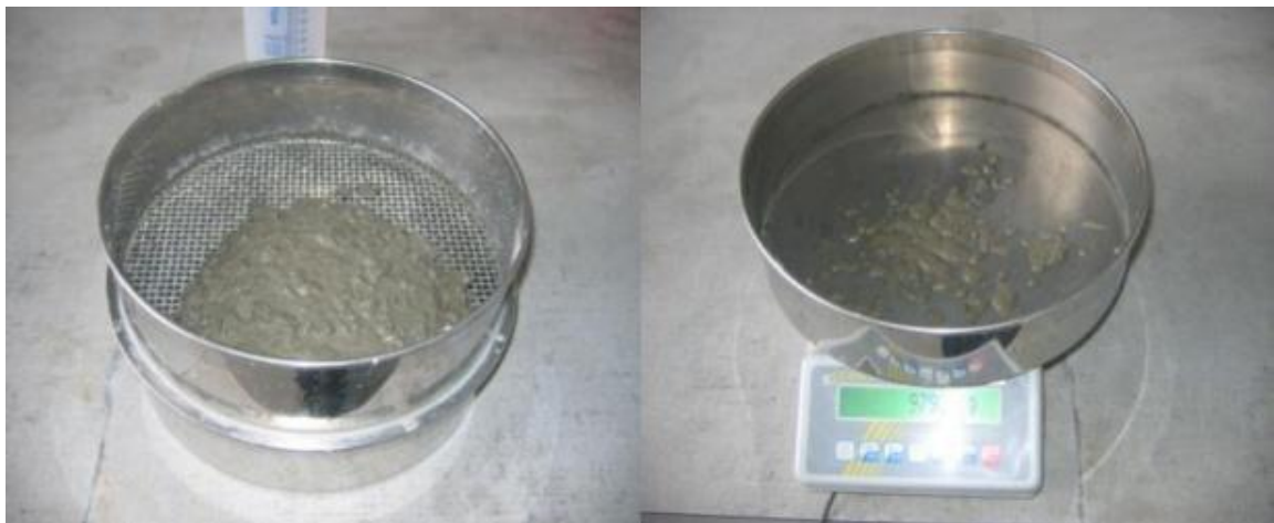
Figure 4 : Essai de stabilité au tamis
