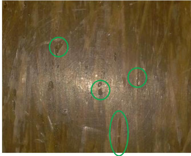
**Photo 21. Défauts de surface des composites renforcés de raphia**
