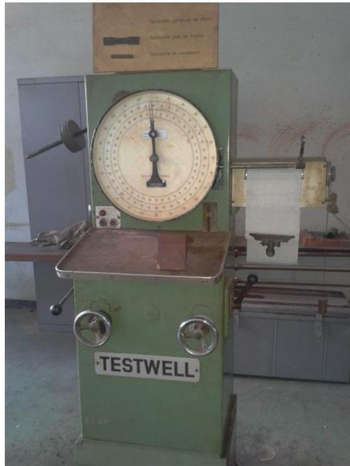
**Photo 6. Machine utilisée pour l'essai de flexion**
