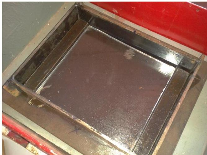
**Photo 4. Moule formé par le cadre et la partie inférieure**
