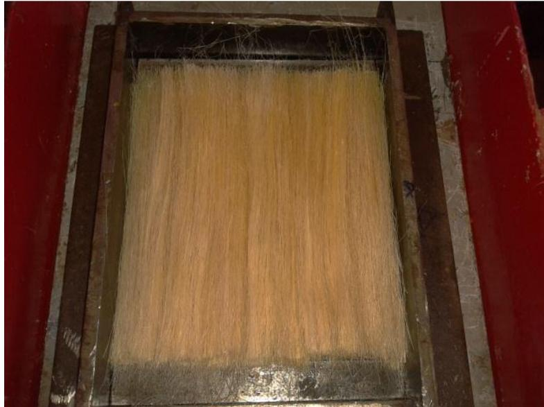
**Photo 15. Mise en place des fibres cardées dans le moule**
