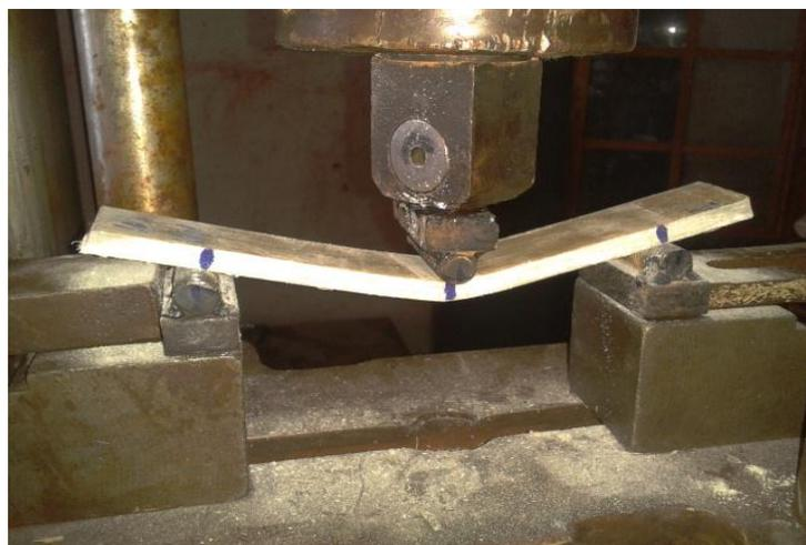
**Photo 8. Éprouvette en rupture**
