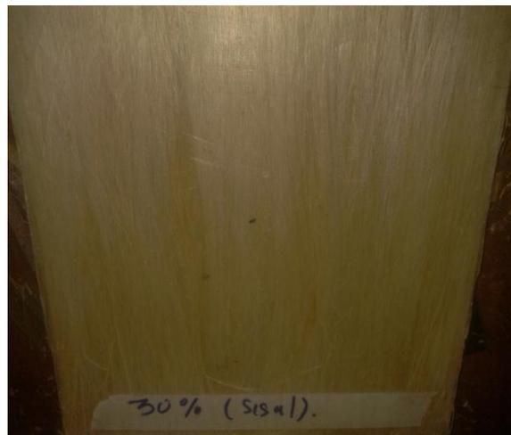
**Photo 16. Composite renforcé de fibres de sisal à 30 %**
