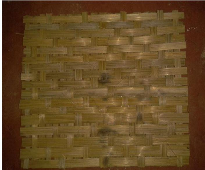
**Photo 13. Armure satin de 5 avec décochement 3 de lattes de bambou**
