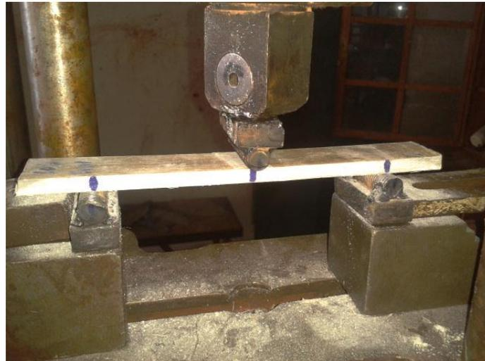
**Photo 7. Positionnement de l'éprouvette sur les deux appuis**
