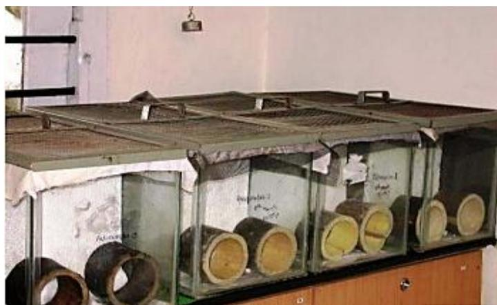
*Photo 8: test de durabilité naturelle des bambous au laboratoire*
