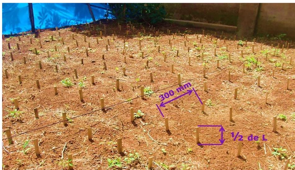
*Photo 11 : graveyard test en suivant la méthode d'Ashaari et Mamat, (2000)*
